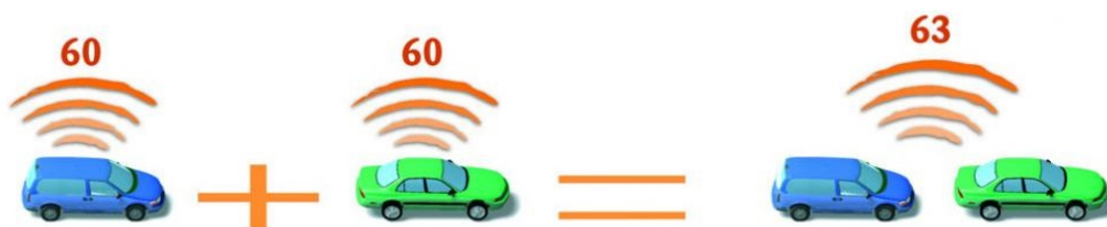
Figure 3 – Addition de 2 sources de même intensité
