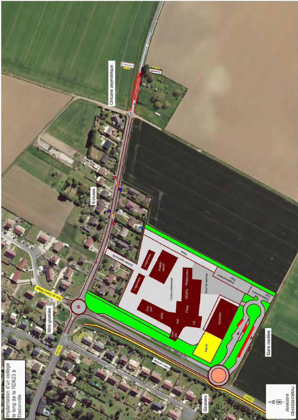
Figure 1 : Schéma de l'aménagement retenu pour le projet de construction d'un nouveau collège sur la commune de Dadonville (collège, constructions annexes et réseau viaire) – Département du Loiret
