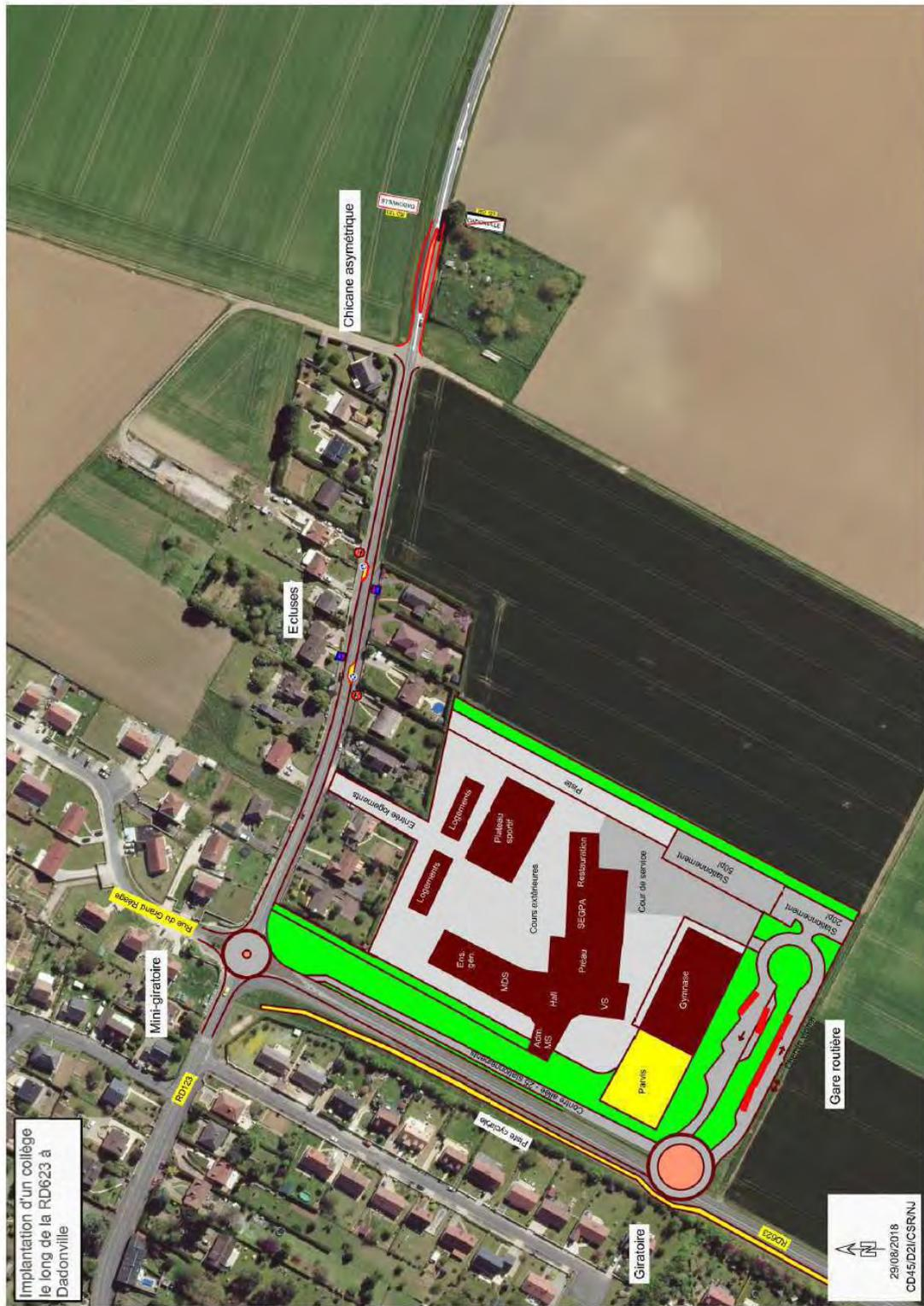
Hypothèse de schéma du projet global, contenant les aménagements du réseau viaire situé à proximité du projet de collège - Département du Loiret - ce schéma ne donne aucune préconisation architecturale, il a pour seul objectif de vérifier que l'ensemble des locaux peuvent être implantés sur le site retenu
