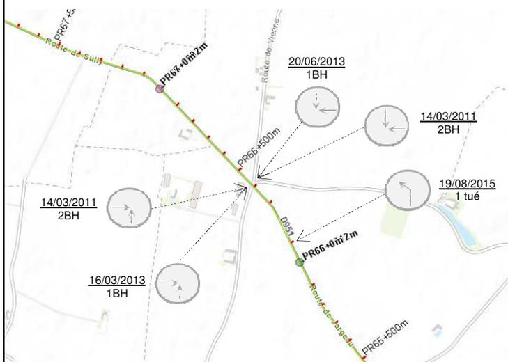
➤ L'accidentologie démontre un problème de lisibilité du carrefour renforcée par le caractère rectiligne des sections.
