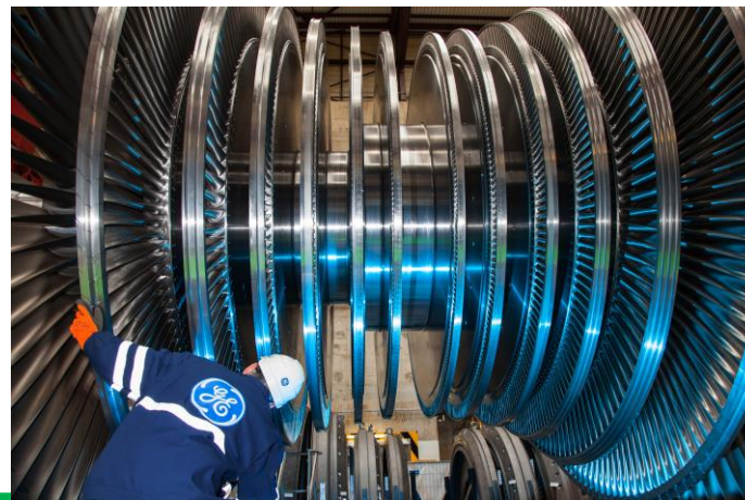
Remplacement de la ligne d'arbre du Groupe Turbo Alternateur Tr 2 et 3 en 2015/2016 – Gain de 30 MW / Tr
