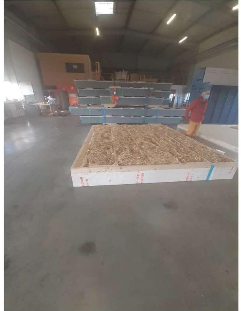
**d) Fermeture du mur avec le pare-vapeur :**
