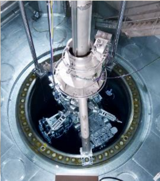
Machine d'inspection en service : contrôle de l'intégrité et la résistance de la cuve
